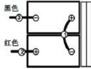
示连接电瓶电缆线 机器正面
